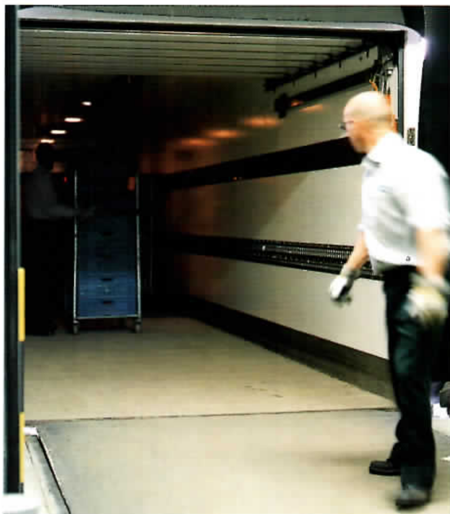
GELADEN DRUKKEN DE WIELEN VAN DE ROLCONTAINERS ALTIJD OP DE DEZELFDE PLAATS. LEEG GEVEN ZE DOOR HET SCHUIVEN EN DRAAIEN VAN DE WIELEN OP DIE PLEK SNIJTBELASTING.
