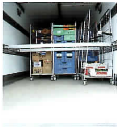
GELADEN DRUKKEN DE WIELEN VAN DE ROLCONTAINERS ALTIJD OP DE DEZELFDE PLAATS. LEEG GEVEN ZE DOOR HET SCHUIVEN EN DRAAIEN VAN DE WIELEN OP DIE PLEK SNIJTBELASTING.
