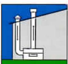
Gesloten opstelling met verticale aan- en afvoer
